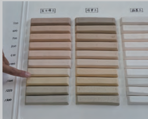
電気窯にならぶ焼成前のタイル 焼成温度別の陶サンプル (岐阜県立多治見工業高等学校)
