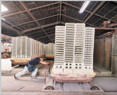
焼成トンネル窯 匣鉢に詰められた焼成前のタイル (鈴製陶株式会社)
